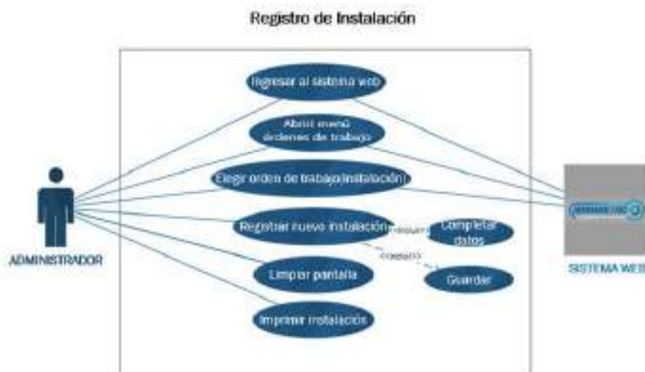
Figura 20. Diagrama de caso de uso para registro de instalación
