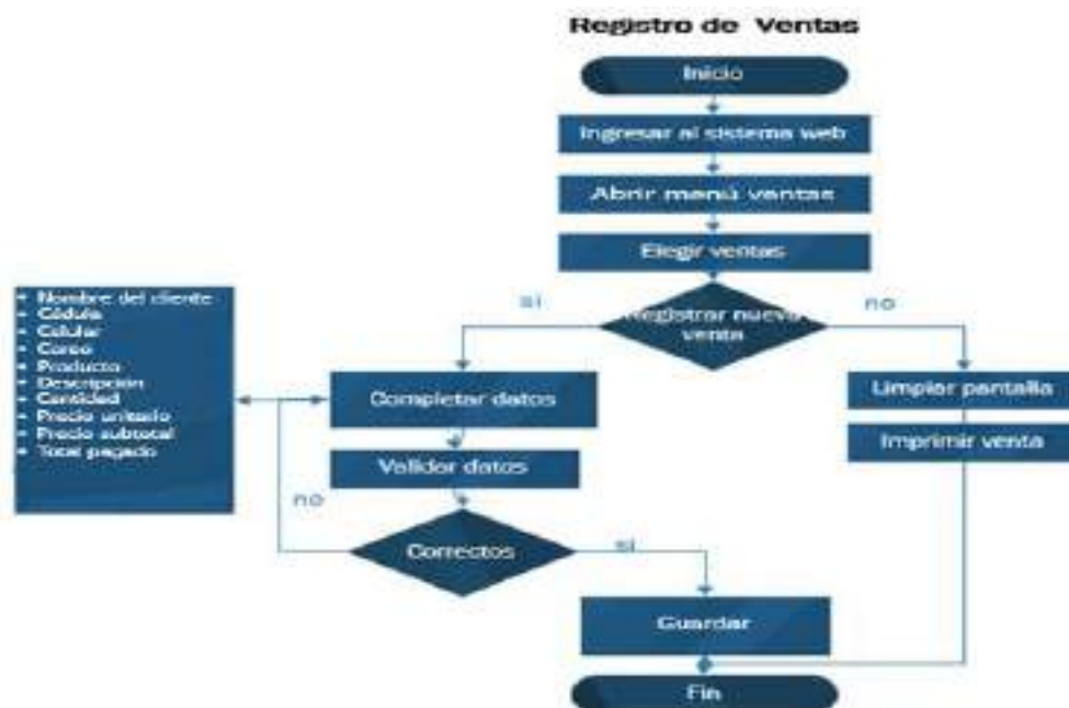
Figura 37. Diagrama de flujo de datos para registro de venta
