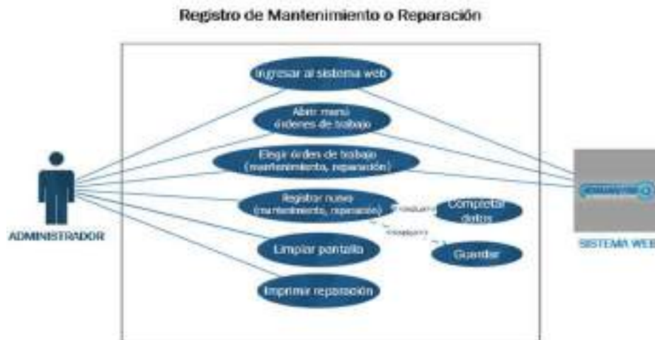
Figura 21. Diagrama de caso de uso para registro de mantenimiento y reparación
